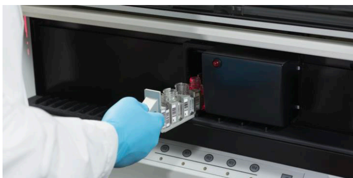
O leitor de código de barras integrado permite o gerenciamento de reagentes em tempo real.
